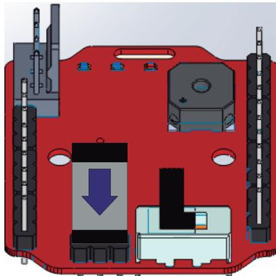
Conexão do conector da bateria
