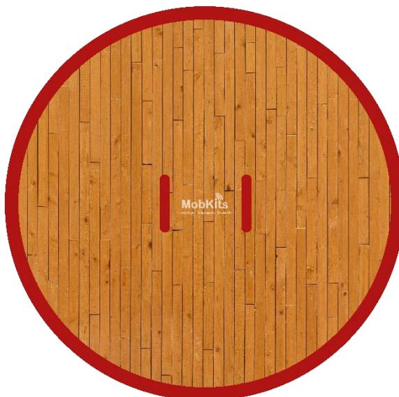
A arena é fabricada em lona ou mdf. A área útil do combate corresponde ao formato circular com diâmetro de 82cm. O espaçamento entre as linhas de posicionamento dos robôs é de 19cm. A arena estará a aproximadamente 5cm de altura do chão.
